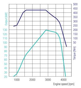
**4P10 – 129 kW (175 PS)** 430 Nm@1600 rpm 129 kW@2865 rpm
