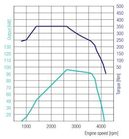
**4P10 – 96 kW (130 PS)** 350 Nm@1400 rpm 96 kW@2620 rpm
